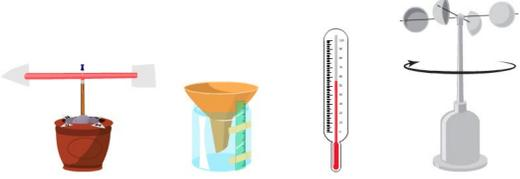
Veleta Pluviómetro Termómetro Anemómetro
