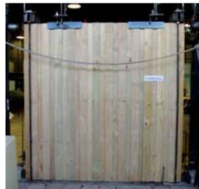
**ENSAYO MONOTÓNICO DE CORTE – FLEXIÓN**
