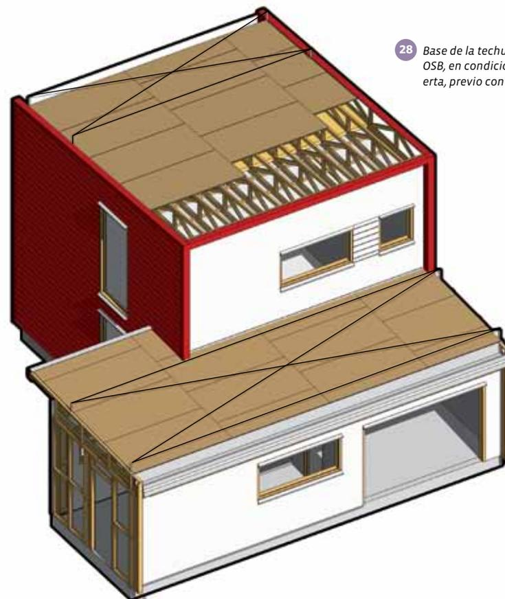
**28** Base de la techumbre, de tableros de OSB, en condiciones de recibir la cubierta, previo control geométrico.
