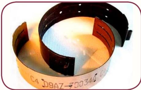
**Las Bandas** también son elementos de fijación, que se utilizan (al igual que los discos) para frenar o fijar algún componente, la diferencia está en que, por sus características, las Bandas fijan a los tambores que forman parte de la Transmisión automática.
