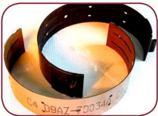
**Las Bandas** también son elementos de fijación, que se utilizan (al igual que los discos) para frenar o fijar algún componente, la diferencia está en que, por sus características, las Bandas fijan a los tambores que forman parte de la Transmisión automática.
