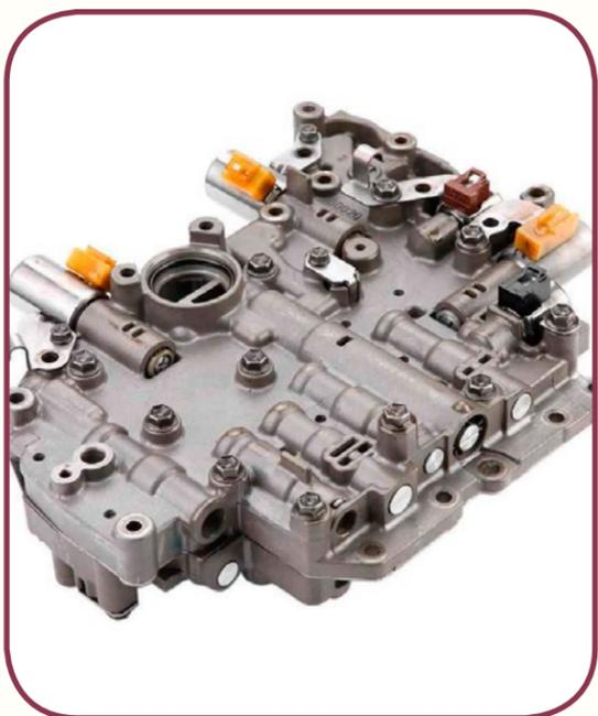
Para el correcto funcionamiento de la transmisión, es fundamental contar con elementos que se encarguen de administrar y regular las presiones hidráulicas que se generan en el Sistema Hidráulico. Para eso es que existe el **Cuerpo o Caja de Válvulas** montado en el interior de la transmisión, el cual consta con conductos internos y además se montan electro válvulas de control, llamadas habitualmente Electro Válvulas o Válvulas Solenoides.
