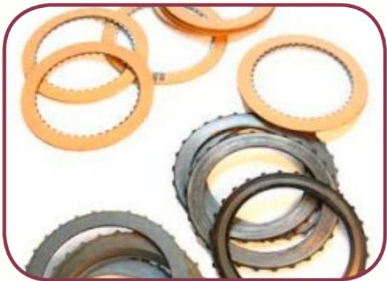
Habitualmente los **Discos Metálicos** van conectados a la carcasa de la transmisión, y los discos de fricción van conectados con el componente a frenar o fijar en forma intercalada, es decir, se pone un disco de fricción y uno metálico.
