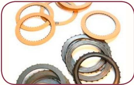
Habitualmente los **Discos Metálicos** van conectados a la carcasa de la transmisión, y los discos de fricción van conectados con el componente a frenar o fijar en forma intercalada, es decir, se pone un disco de fricción y uno metálico.
