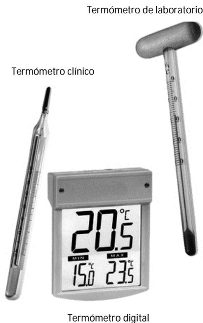
Los termómetros son instrumentos para medir la temperatura del ambiente, de una persona, de un animal... o de lo que te imagines. La verdad es que puedes medir la temperatura de casi cualquier cosa con un termómetro adecuado.
