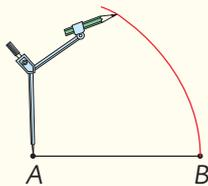
Dibujó un arco centrado el compás en A y usando una abertura igual al segmento  $\overline{AB}$ .
