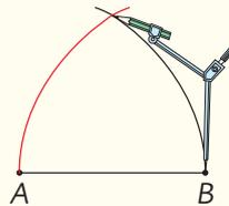
Usando la misma abertura del paso anterior, dibujó un arco centrado el compás en B.
